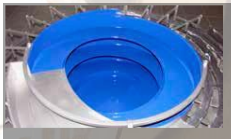
MetaLine® Serija 700 - izuzetno otporna na habanje i udarce za debljine premaza od 1,5 mm naviše, i jednostavnije geometrije komponenti.
