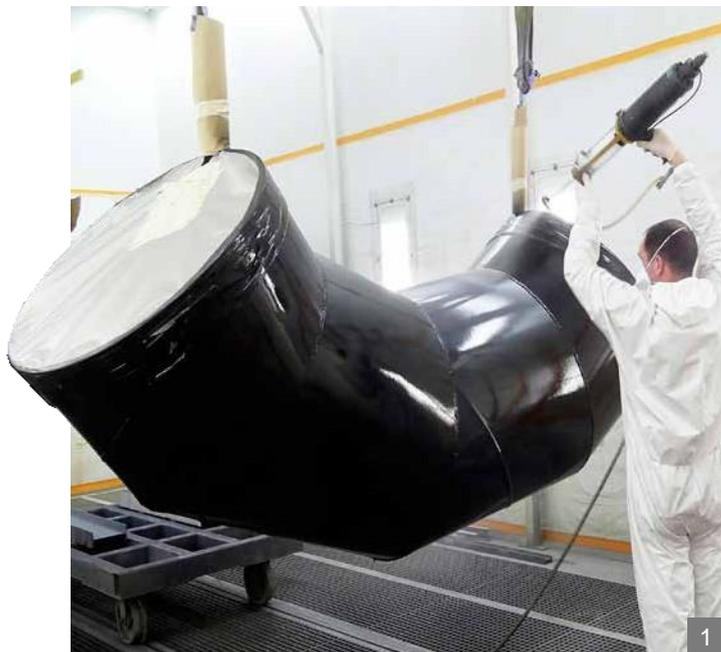
Raspršivi, elastomerni premazi za početno premazivanje ili popravku ukopanih cevovoda. Ovaj izdržljivi premaz pruža zaštitu od korozije i vremenskih uticaja, posebno za primenu na licu mesta radi pokrivanja zavarenih spojeva.
